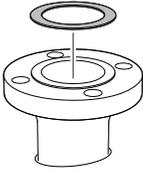
**Schritt 3: Spülring auf die Dichtung setzen**
